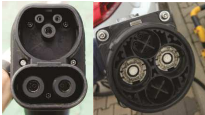
Rysunek 3 Graficzny zarys wtyczek: po lewej typ 2 COMBO (CCS) oraz po prawej typ CHADEMO 4
